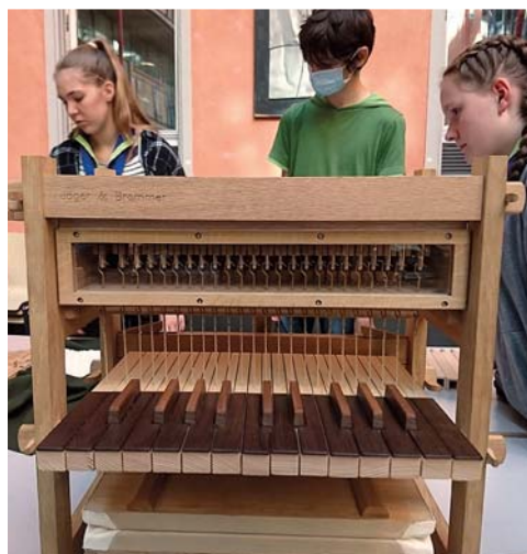
Mit zwei Blasebälgen wird Luft in das Instrument getrieben.
