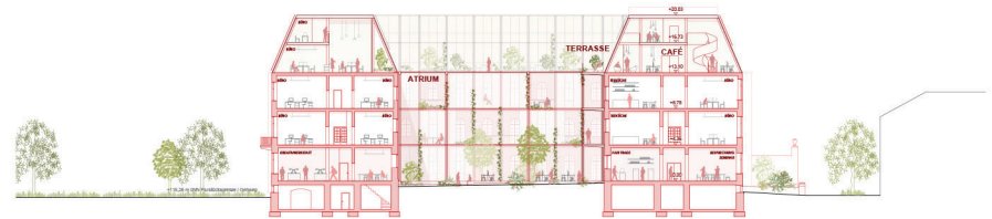
QUERSCHNITT 1-1 1:200 DAS ATRIUM FUNKTIONIERT ALS EINBEGLEITET ALLER NUTZUNGSEINHEITEN UND IST DAS HERZ DES „ROTEN HAUSES“ | DIE EINHEITEN IM ERDGESCHOSS ÖFFNEN SICH AKTIV ZUM ATRIUM UND KNÜPFEN SO VERBINDUNGEN UNTERNEANDER
